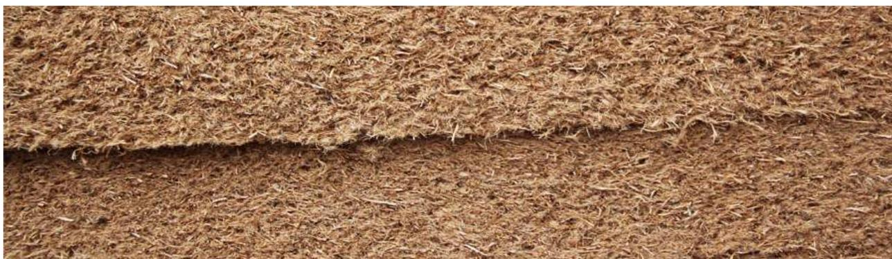
Un discorso analogo a quello delle lane minerali può valere anche per le Fibre di legno. Queste vengono realizzate utilizzando residui di segheria. Il legno viene frantumato e scomposto in fibre che vengono in seguito compattate.
